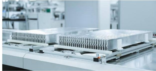
Ilustración 3. Batería tipo Blade, de BYD.
