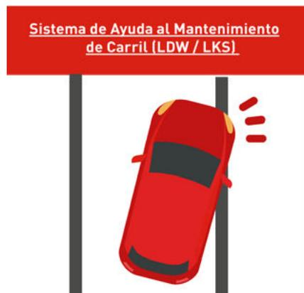
**Sistema de Ayuda al Mantenimiento de Carril (LDW / LKS):** evita salidas de la vía mediante el aviso al conductor o tomando el control de la dirección del vehículo de forma intermitente.
