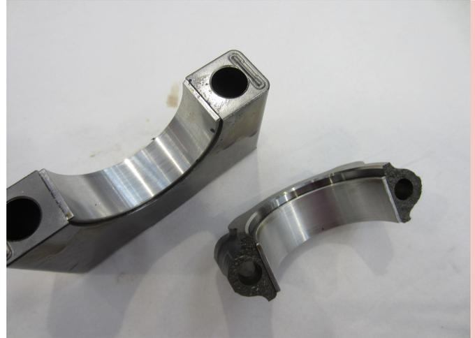
Imagen 39: Casquillos de biela y de bancada del vehículo de gasolina.
