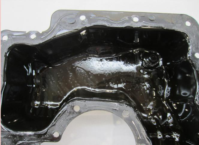
Imagen 38: Cárter del vehículo de gasolina.
