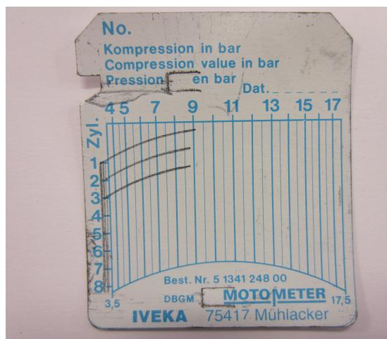
Imágenes 31 y 32: Resultado de la compresión del motor del vehículo gasolina, antes y después de la prueba.
