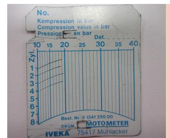
Imágenes 16 y 17: Resultado de la compresión del motor diésel antes y después del encendido del testigo.
