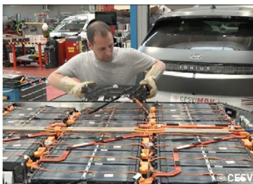
Imagen 34: Desmontaje del módulo defectuoso
