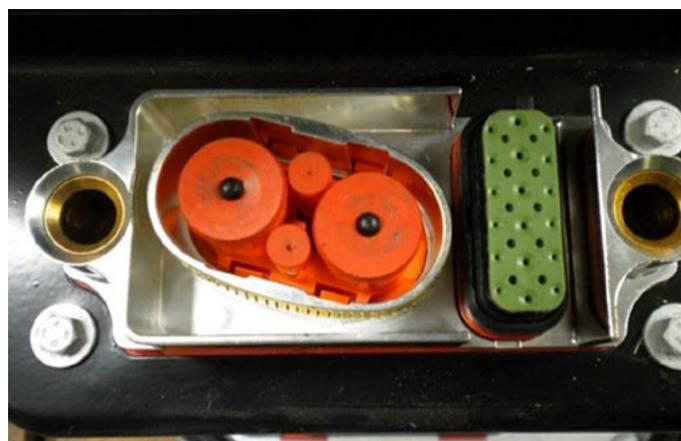
Imagen 33: Conectores rápidos y orificios de centrado de la batería
