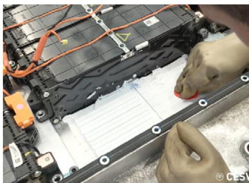
Imagen 35: Reposición de la pasta conductora del calor
