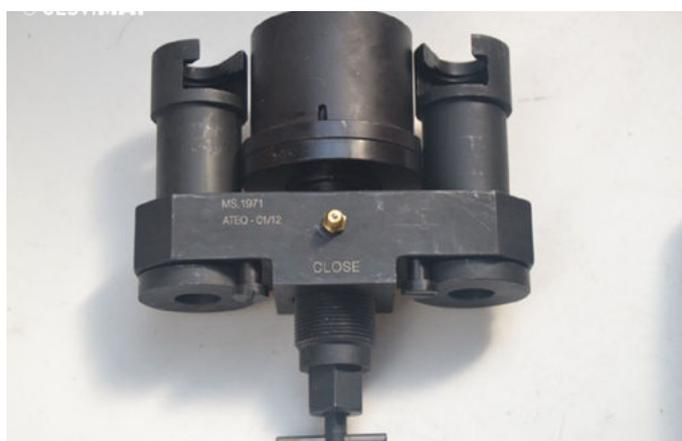
Imagen 32: Útil específico para desmontaje de baterías del Renault Fluence ZE (MS 1971) con sistema *QuickDrop*
