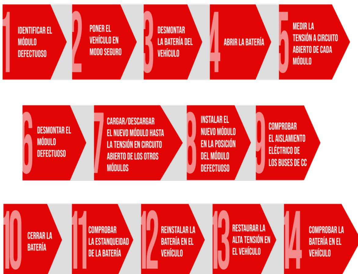
Gráfico 4: Diagrama del proceso de reparación de baterías por sustitución de módulos
