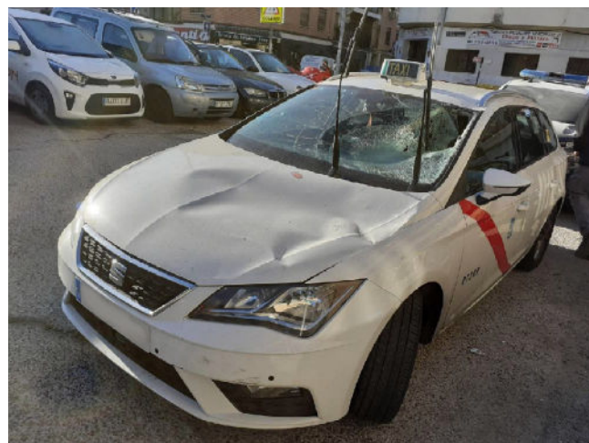
Ilustración 8: Estado del vehículo tras un atropello a alta velocidad
