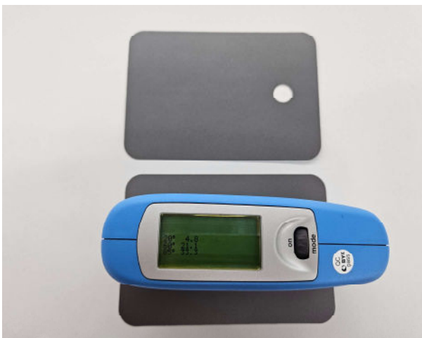
Medición de brillo. Probetas con diferente carga de barniz y misma marca de pintura
