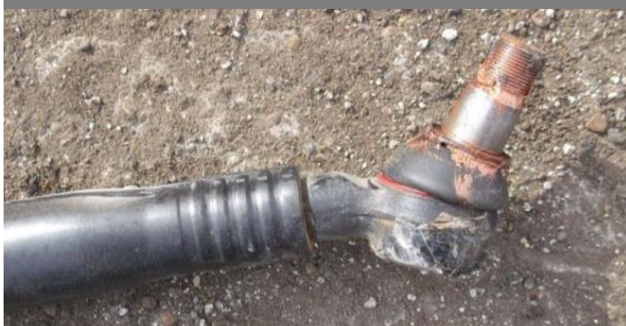
DEFORMACIÓN DE RÓTULA DE LA BARRA DE MANDO DEL SISTEMA DE DIRECCIÓN
