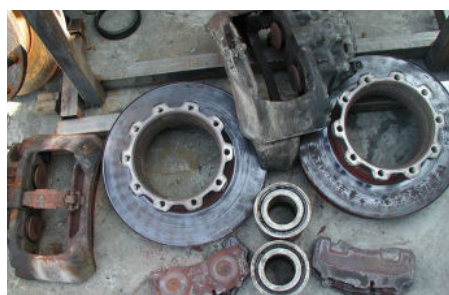
Sistema de frenos de disco de camión sobrecalentados.
