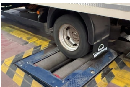
Revisión de los frenos de un camión con frenómetro, en ITV.
