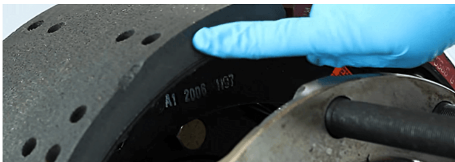
Revisión visual de la zapata de freno.
