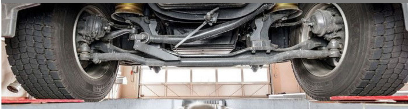
SUSPENSIÓN NEUMÁTICA DELANTERA DE TRACTORA
