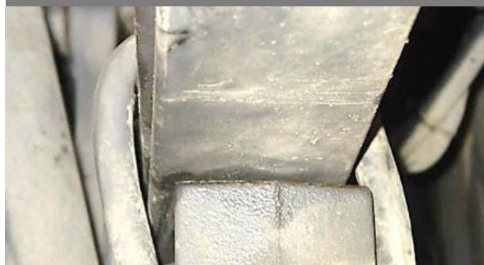
ABARCÓN DE SUSPENSIÓN DEFORMADO POR DESPLAZAMIENTO DE BALLESTA
