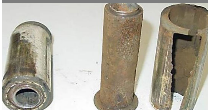
SILENTBLOCKS DE BALLESTA DESGASTADOS POR EL USO
