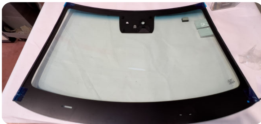
Ilustración 6. Luna de la marca XYG con el soporte de la cámara integrado. Fuente: Cesvimap
