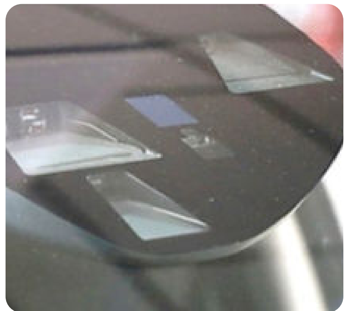
Ilustración 2: Sistemas ADAS en parabrisas. Fuente: Cesvimap
