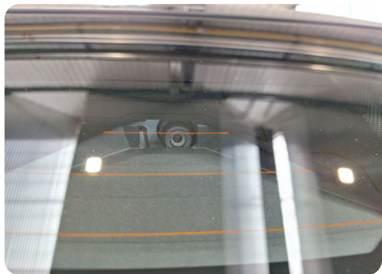
Ilustración 5. Cámara ADAS mal posicionada. Fuente: Cesvimap
