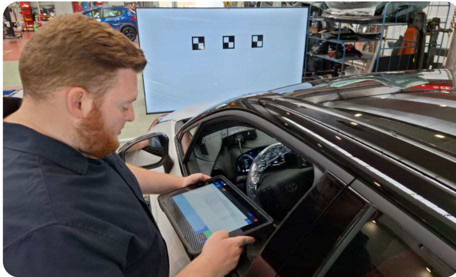
Ilustración 3. Calibración estática de cámaras ADAS. Fuente: Cesvimap
