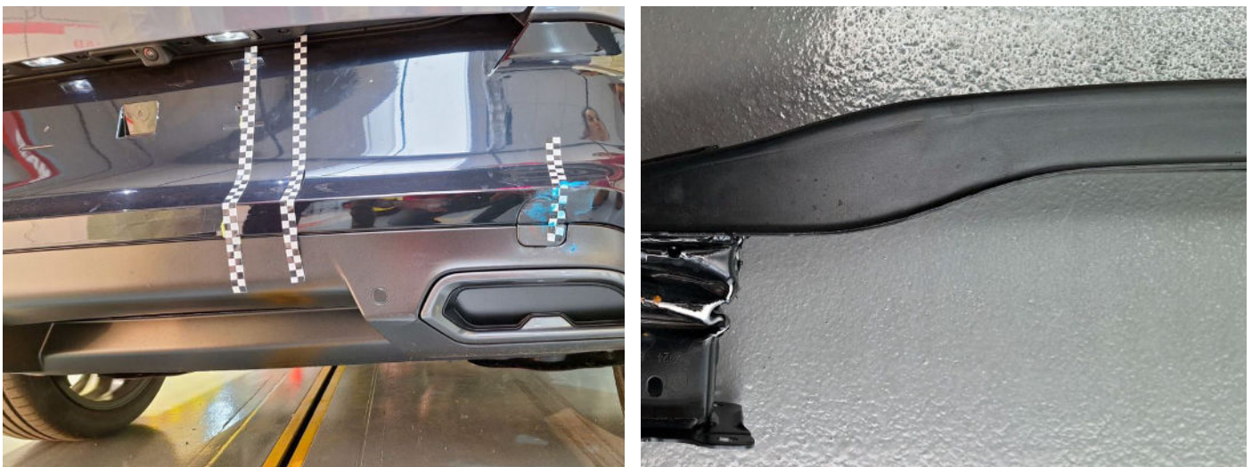
Figura 4: Daños exteriores e interiores con resultado de VEB 10 km/h y delta V del vehículo de 8,89 km/h Fuente: Cevimap
